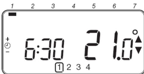
b. Pro nastavení začátku období použijte tlačítka nebo , displej přestane blikat a ukazatel OK? se zobrazí. Přidržením tlačítka se čas rychle změní.
