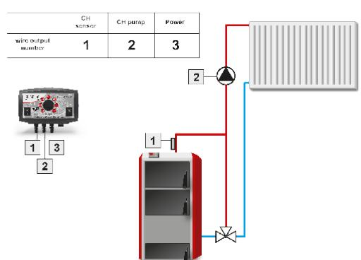
• Teplotní čidlo se umísťuje do jímky v kotli nebo se přichytí stahovací páskou na výstupní trubku teplé vody z kotle a dobře zaizoluje. Čidlo nelze vkládat do žádné kapaliny.
